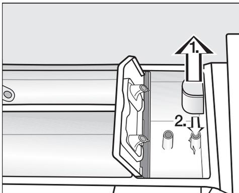
1. Saugheber aus der Kammer
