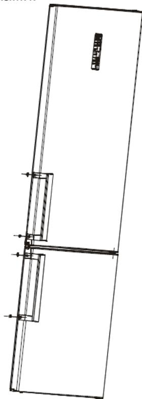
5) Извлеките винты и снимите ручки.
