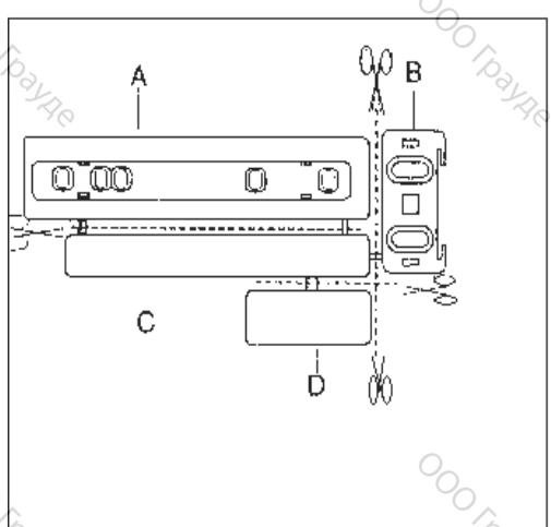
**4.** Поместите направляющую (A) на внутреннюю часть мебельной двери сверху и снизу, как показано на рисунке, и отметьте положение внешних отверстий. Проделайте с помощью дрели отверстия и закрепите направляющие с помощью шурупов, входящих в комплект поставки.
